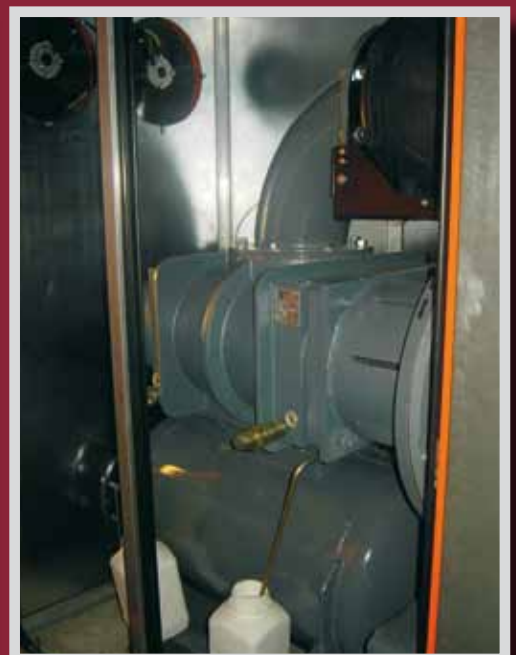
Vakuumentgasung Polyamid / extruder degasing polyamid
