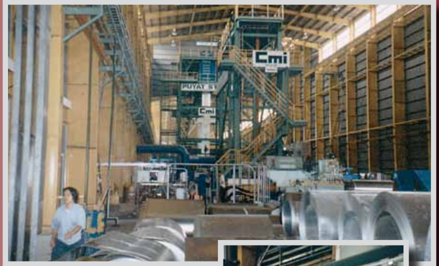
Regeneration von Adsorptions- kolonnen für Stahlherstellung / regeneration of adsorber columns at steel production
