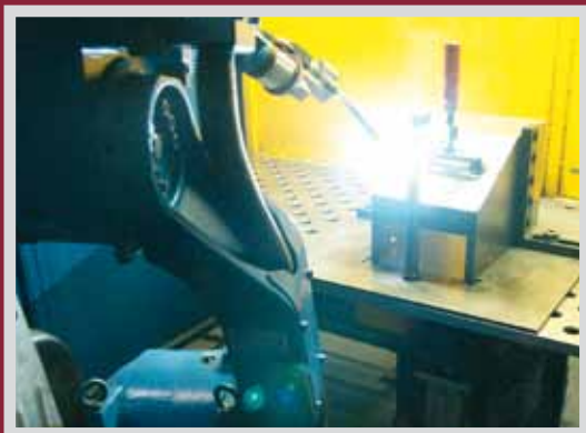
Laserbearbeitung von Ansauggehäusen / laser machining suction silencer
