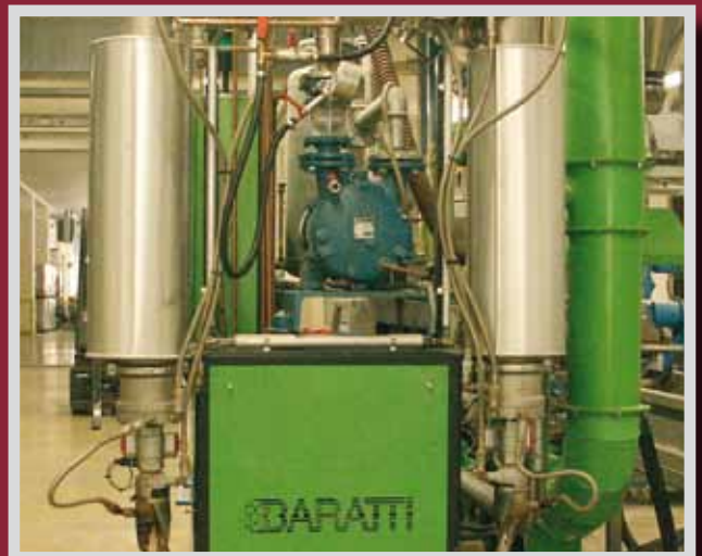
Vakuumentgasung Polyamid / extruder degasing polyamid
