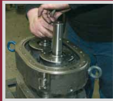
Montage Gebläseeinheit / assembling blower stage
