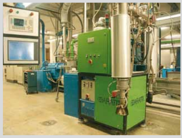
Vakuumentgasung Polyamid / vacuum degassing of polyamid extruder
