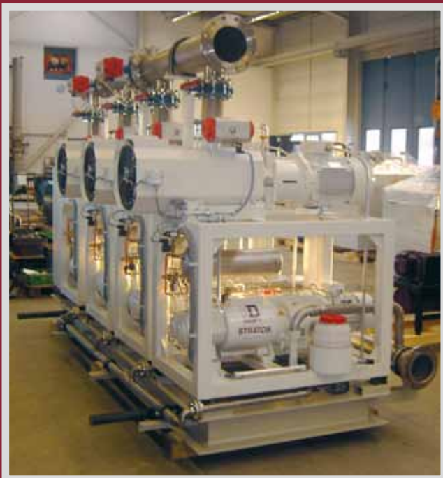
trockenlaufende Vakuumpumpstände PET Entgasung STRATOS/ATMOS / dryrunning vacuum systems for PET degassing range STRATOS/ATMOS
