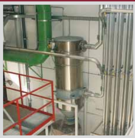
Vakuumzentralfilter für Zentralversorgung oder Staubsauganlage / centralized system for vacuum cleaning of production integrated in conveying system
