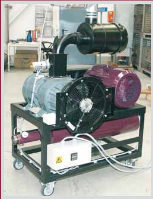
Vakuumgebläse ATMOS V4, Einsatz pneumatische Förderung / Blower ATMOS V 4 KR- pneumatic conveying
