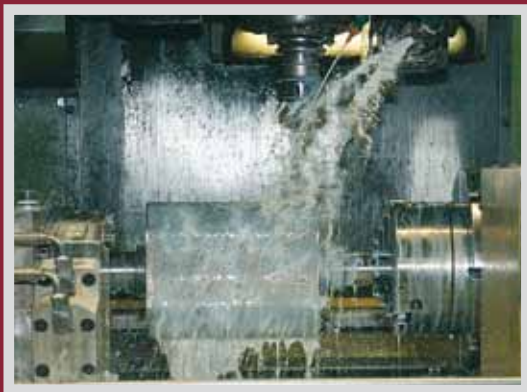
CNC-Bearbeitung Drehkolben / CNC lobe machining
